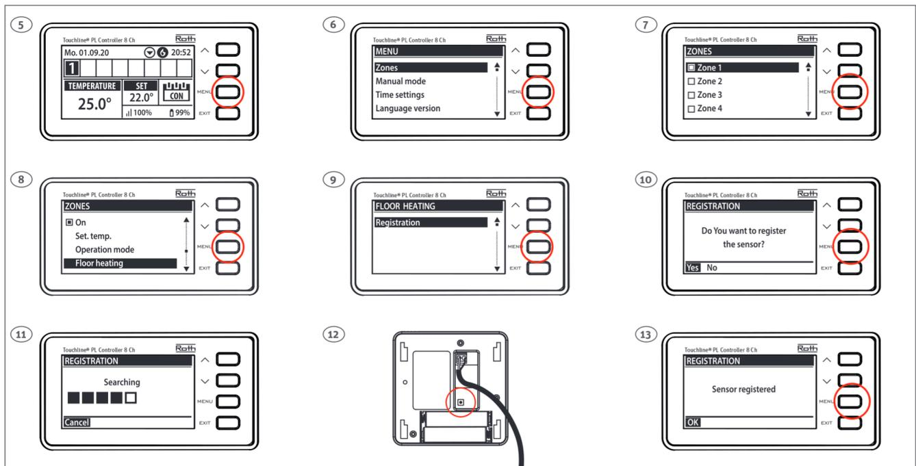
**(DK)** Gulvføleren kan kun anvendes i kombination med en rumtermostat. Så tilmeld først rumtermostaten til kanalen og derefter gulvføleren til samme kanal. Alle forbindelser til pumpe, termomotorer og evt. relæ skal gøres inden der sættes 230 V til kontrolenheden. Tryk på den lille knap kortvarigt (se tegning 12) når der i displayet står "Searching". Læs manualen for kontrolenheden.
