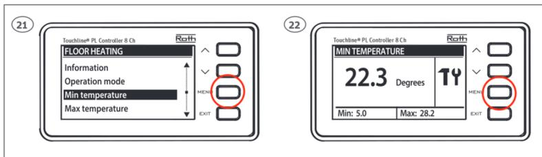
**(DK)** OBS! Når gulvføleren anvendes til "Beskyttelse af gulvet" vil opvarmningen stoppe hvis temperaturen overstiger den indstillede max. temperatur. Når gulvføleren anvendes til "Komfort" har rumtermostaten prioritet så længe temperaturen ligger imellem indstillet min. og max. temperaturer.
