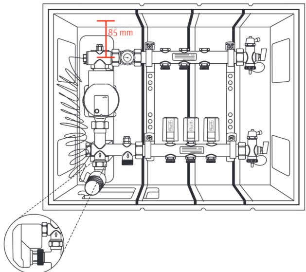
**(DK)** Afslut montering ved at trykke låget på. Isoleringen kan afkortes efter behov i skærerillerne markeret i fronten og hele vejen rundt om isoleringen. Enderne flyttes herefter ind for tilpasning.
