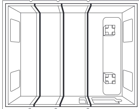
**(DK)** Shunten placeres på de formstøbte tårne, herefter kontrolmåles der fra top til midt rør som vist på tegning. Der skal være 85 mm. Ved montage af motorventil for vejrkompensering vendes ventilen som vist på tegning.
