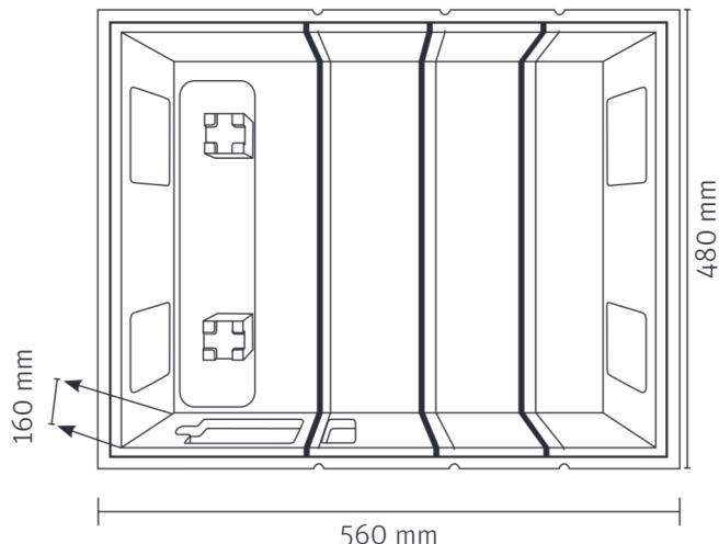
**(DK)** Shunten placeres på de formstøbte tårne, herefter kontrollmåles der fra top til midt rør som vist på tegning. Der skal være 85 mm. Ved montering af motorventil til vejrkompensering vendes ventilen som vist på tegning.
