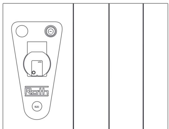
**(DK)** Isoleringen kan også spejlvendes hvis pumpen ønskes til højre. Vend isoleringen så de formstøbte tårne er i højre side, og afslut med at bytte om på top- og bundplade så hullerne igen er placeret i bunden.
