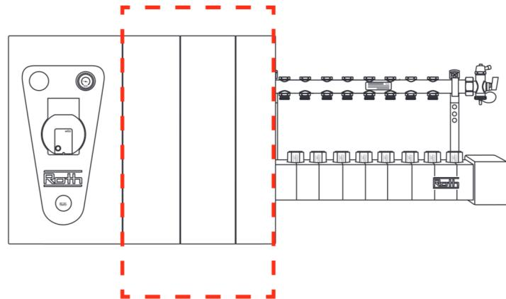
**(DK)** Isoleringen kan afkortes efter behov i skærerillerne markeret i fronten og hele vejen rundt om isoleringen, enderne flyttes herefter ind for tilpasning. *OBS! Tilskæring gøres altid inden montage af GV Shunt.*
