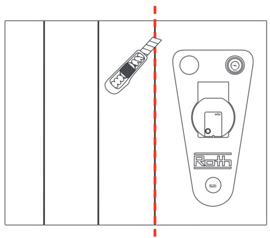
**(DK)** Isoleringen kan udvides med tilhørende isoleringskappe (VVS nr. 401973.890) som vist på tegning. Udskæringer for udvidelse fortages i endernes skæreriller.
