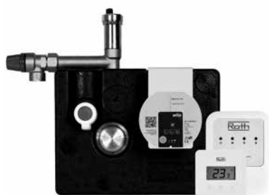
Roth Minishunt Plus med trådløs regulering og varmeelement Leveres uden fordelerkoblinger. Roth Minishunt Plus med trådløs rumtermostat, modtager, termomotor og 500W varmeelement. Leveres inkl. isolering som opfylder kravene i DS 452.
