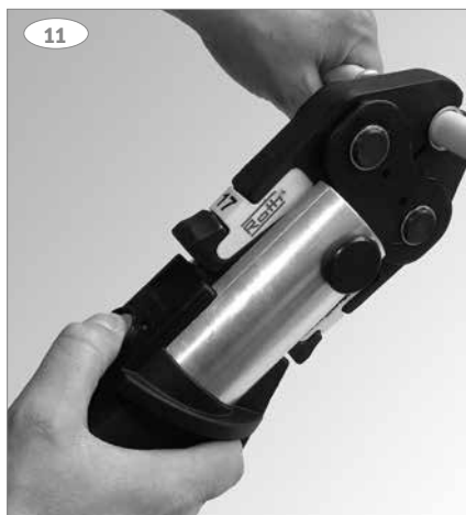
11 + 12: Start presmaskinen og fjern maskinen når der er færdigpresset.
