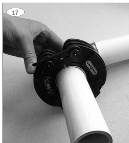
14: Placer preskæden på PressCheck® presringen.
