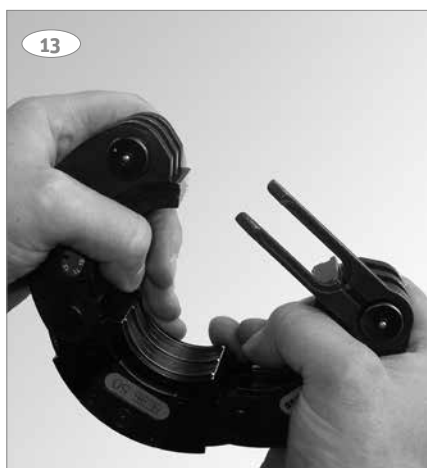
13: Ved pres på 40, 50 og 63 mm bruges Roth preskæder. Åbn preskæden ved hjælp af den fjederbelastede bolt.
